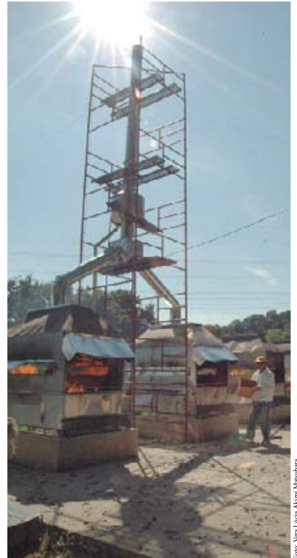
Filtro de fumaça foi testado. Aparelho diminui emissão de monóxido de carbono e de fuligem.
